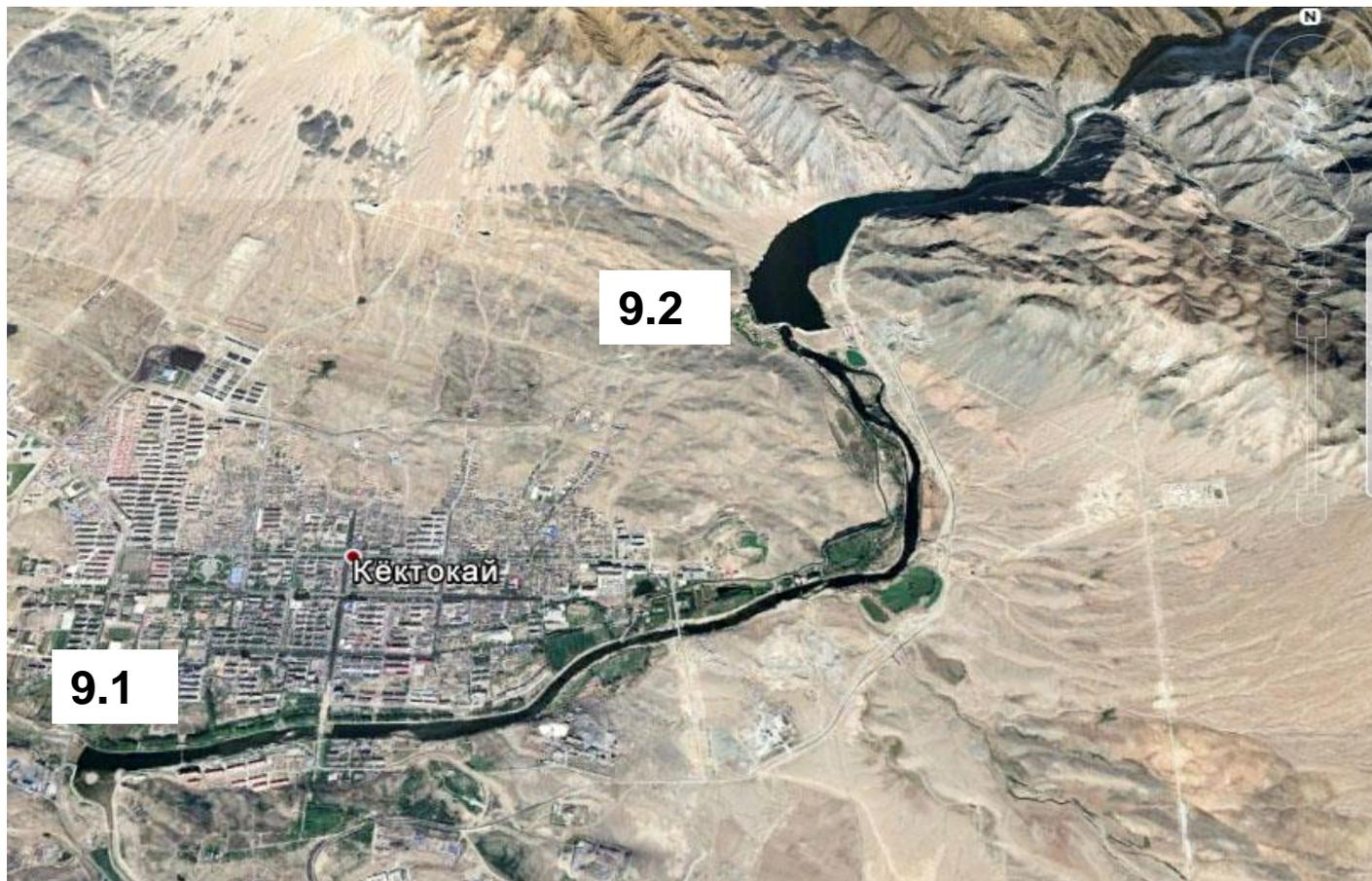
Каскад водохранилищ сезонного регулирования руслового типа, построены на реке. Основное назначение – гидроэнергетическое и ирригационное. Образуется грунтовой и железобетонной плотиной.
