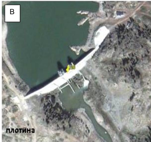
**Водохранилище 26** – водохранилище сезонного регулирования, высокогорное. Образовано в 2003г. с помощью железобетонной арочной плотины на месте слияния двух высокогорных рек в реку Курты (правый приток р. Черный Ертис). Заполнение водохранилища происходит по обеим рекам
